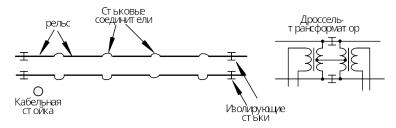
Стыковые соединители устанавливают для устойчивой работы рельсовых цепей на стыках рельсов стальные или медные. В зависимости от способа присоединения к рельсам они подразделяются на штепсельные и приварные.
